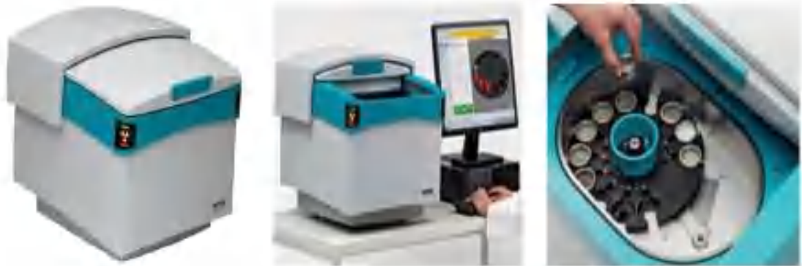
a) Hình dạng hệ ED-XRF b) Hệ ED-XRF kết nối với máy tính c) Bên trong hệ ED-XRF ở các vị trí đặt mẫu
