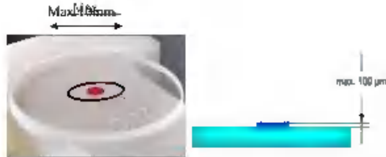
Hình 2.19. Đường kính và độ dày tối đa của mẫu (Bruker, S2 PICOFOX™, 2018)
